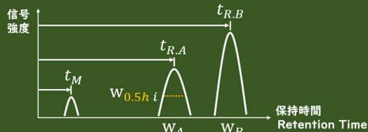
$t_M$  に移動相の流量F を乗することで、移動相が通過できる体積  $V_M$  (移動相の体積) がわかる。
